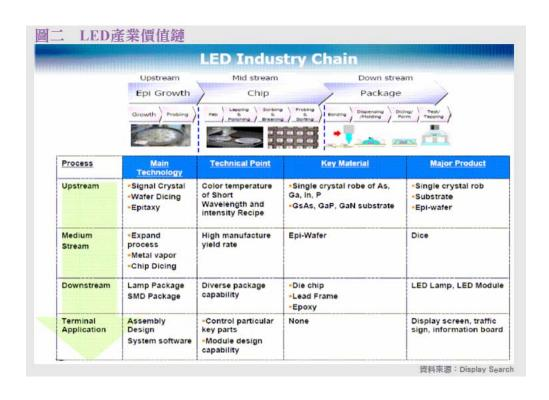
發光二極體(LED)整體產業依據製程區分為上游單晶片(Single Crystal)與磊晶片(Epi-wafer) 製造、中游晶粒製造、下游封裝業及顯示應用。
